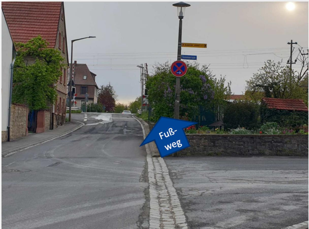
*Durch die Errichtung des Fußwegs könnten die LKW der Fa. Kabus das Firmengelände von Albertshausen aus kommend anfahren. Derzeit ist dies nicht möglich, da der Kurvenradius für LKW zu eng ist. Mit dem Bau des Fußwegs kann die Hauptstraße für alle LKW gesperrt werden. Dies hätte eine Entlastung Anwohner der Hauptstraße zur Folge.*
