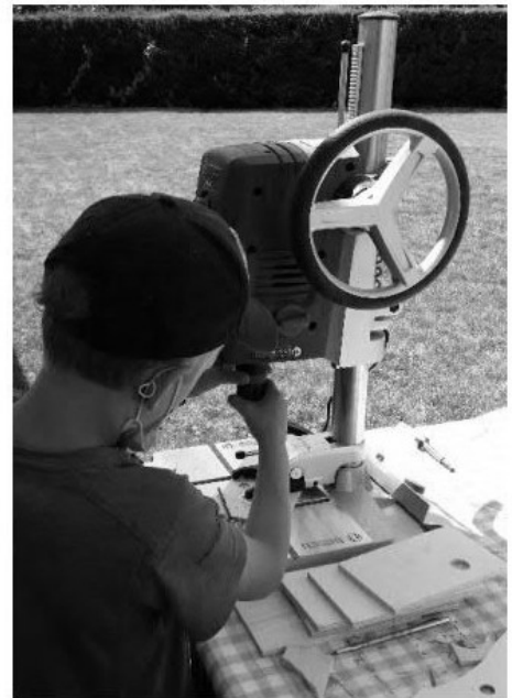
Kilian wechselt den Bohrer an der Ständerbohrmaschine
