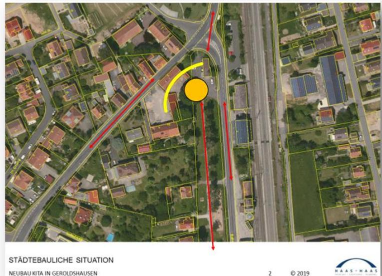
Die Gebäude der ehemalige „Gaststätte Eisenbahn“ mit der Kegelbahn und später auch der Bauhof (orange Grundrisslinien) werden abgerissen. Es werden an deren Stelle die neuen Gebäude der KiTa errichtet. Der Außen-Spielbereich der KiTa befindet sich zwischen der Scheune (grauer Grundriss) und der Kirchheimer Straße. Auf der anderen Seite der neuen Gebäude entsteht bereits in dieser Bauphase mit den beiden großen Bäumen ein Dorfplatz, der durch den Freistaat gefördert werden kann.
