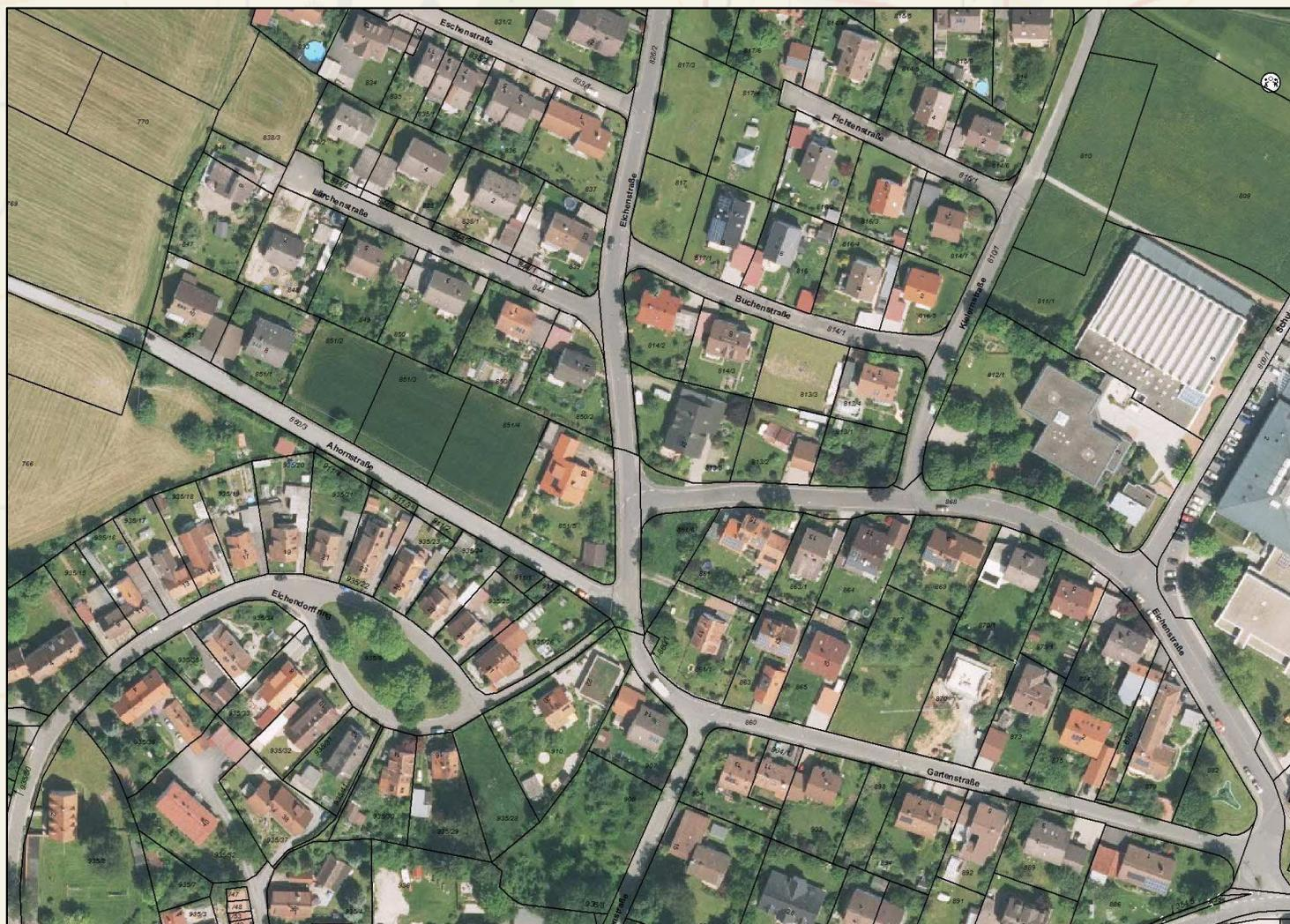
➤ durch Verschneidung der Orthophotos mit der DFK
